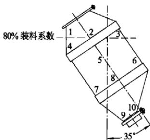
图 A.1 混合桶取样点
